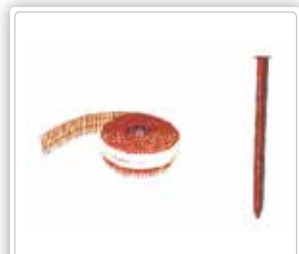
Montážne kľince Materiál: pozinkovaná oceľ Rozmery: 2,5 x 45 mm Balenie: 325 ks / kotúč
